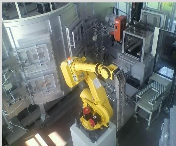
写真2 製品装入/抜去にロボットを活用
