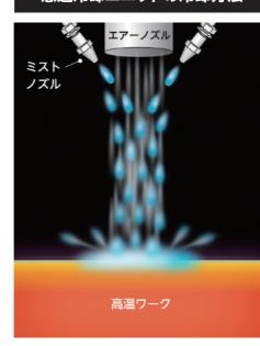
高速の風でミストをワークに衝突させることに よって、効率的な冷却を可能にします。
